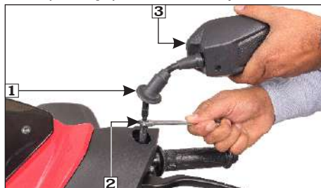
(1) Cubierta antipolvo (2) Contratuerca (3) Espejo retrovisor
