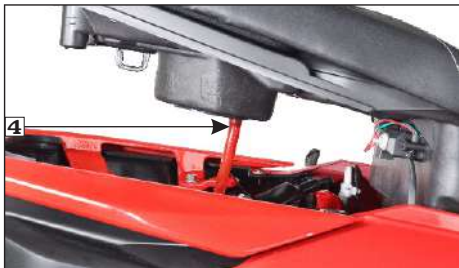
(4) Tubo de drenaje
