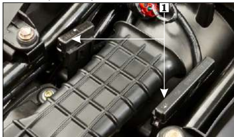
(1) Cajas de fusibles
