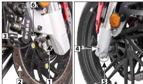
(1) Buje lateral (2) Disco (3) Pinza (4) Tuerca del eje delantero (5) Pernos Allen laterales (6) Sensor de velocidad de la rueda
