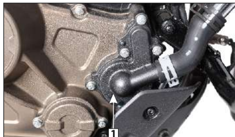
(1) Bomba de agua
