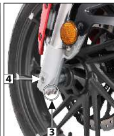
(1) Perno del sensor (2) Sensor de velocidad (3) Pernos Allen laterales (4) Tuerca eje delantero
