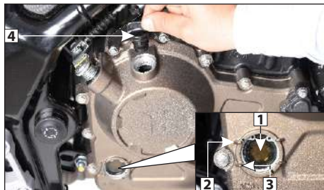
(1) Ventana nivel de aceite (2) Marca superior (3) Marca inferior (4) Tapón de llenado
