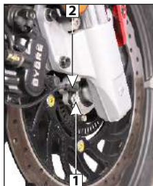
(1) Perno del sensor (2) Sensor de velocidad (3) Pernos Allen laterales (4) Tuerca eje delantero
