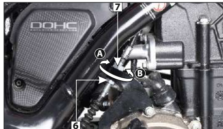
(6) Contratuercas (7) Tuerca de ajuste del cable (A) Disminuir juego libre (B) Aumentar juego libre
