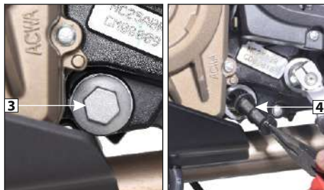
(3) Perno de drenaje de aceite (4) Filtro de malla
