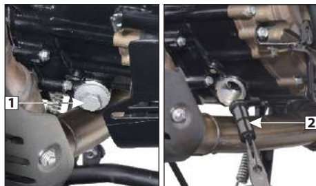
(1) Perno de drenaje de aceite delantero (2) Malla
