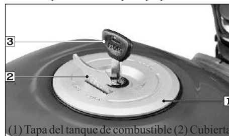
(1) Tapa del tanque de combustible (2) Cubierta de hueco de la llave (3) Llave de encendido
