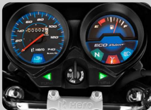
**MEDIDOR DE COMBUSTIBLE Y TESTIGO DE PATA**
