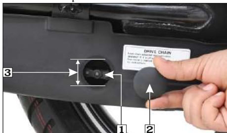
(1) Cadena de transmisión (2) Tapa del orificio (3) Holgura cadena de transmisión: 30 mm
