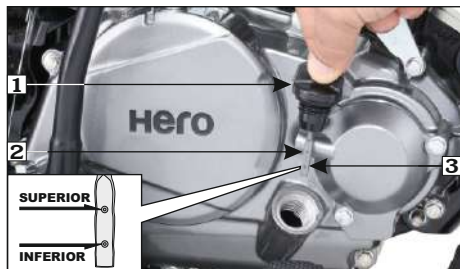
(1) Varilla medidora (2) Marca nivel superior (3) Marca nivel inferior
