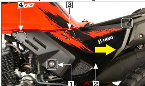
(1) Tornillos cubierta lateral (2) Cubierta
