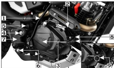
(1) Pedal de arranque (2) Cable de embrague
