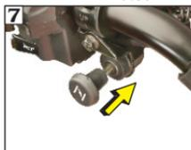
7 Empuje la perilla de arranque hacia adentro a la posición "OFF", como se indica, después de que el motor se caliente lo suficiente para tener una respuesta estable del acelerador.
