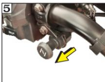
5 Tire de la perilla de arranque hacia afuera a la posición "ON" como se indica (Use el arranque en condiciones de frío).
