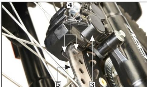
(3) Pinza freno delantero (4) Pastillas de freno (5) Disco
