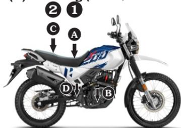
**(A) Asiento conductor (B) Posapiés conductor**
