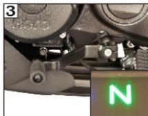
3 Seleccione la posición neutro y verifique que el indicador (N) se ilumine en el grupo de instrumentos con encendido "ON" (O).
