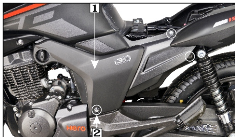
(1) Cubierta lateral (2) Tornillos
