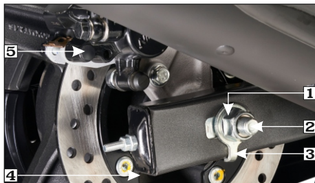
(1) Tuerca del eje trasero (2) Eje (3) Arandela (4) Collarín lateral derecho (5) Conjunto de la pinza
