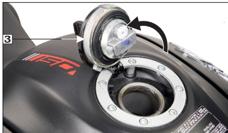
(3) Tapa tanque de combustible
