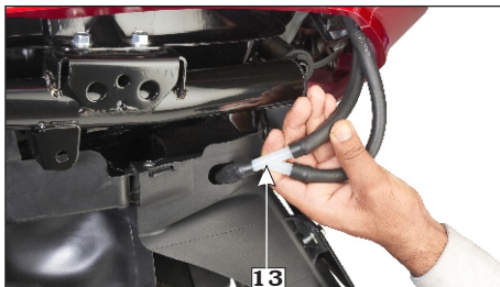
(13) Tubo de drenaje
