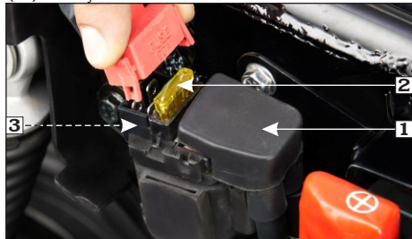
(1) Interruptor del relé magnético (2) Fusible 20A (3) Repuesto 20A
